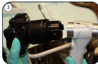
3 Agganciare il VELscope alla macchina fotografica
